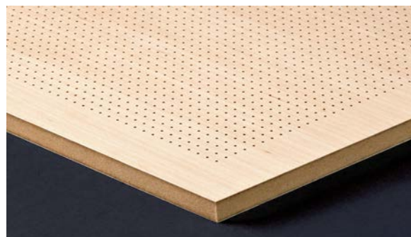
Typ L 1,2/14-8 Sichtseite D=1,2mm Achsabstand 8mm Rückseite T-Lochung D=14mm
