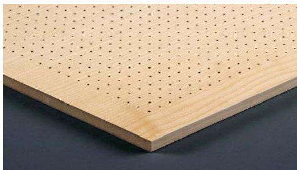
Typ L 1-3 Sichtseite D=1mm Achsabstand 4/6/8/16 +32mm Rückseite T-Lochung D=3mm
