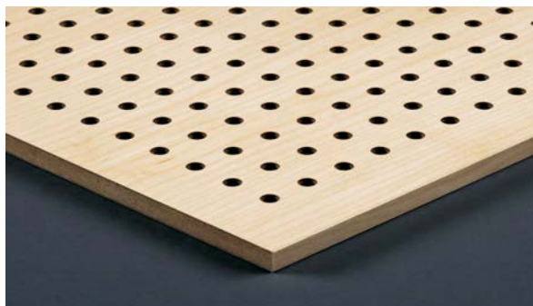
Typ L 6-16 Sichtseite D=6mm Achsabstand 16mm
