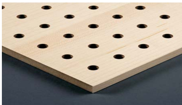
Typ L 10-32 Sichtseite D=10mm Achsabstand 32mm
