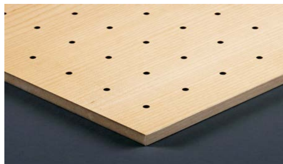
Typ L 4-32 Sichtseite D=4mm Achsabstand 32mm
