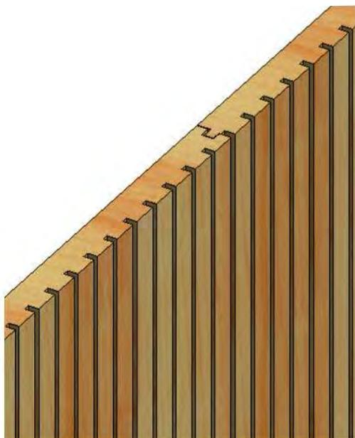
**Bild 1:** Nut- / Kammverbindung
