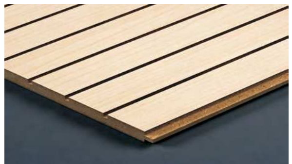
Typ S 3-32, B=3mm, Achsabstand 32mm Typ ST 3-32, B=3mm, Achsabstand 32mm Rückseite teilweise mit zusätzlichen 8mm Ausfräsungen
