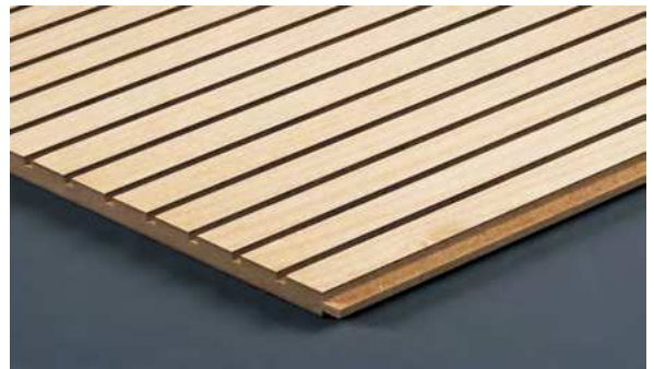
Typ S 3-16, B=3mm, Achsabstand 16mm Typ ST 3-16, B=3mm, Achsabstand 16mm Rückseite teilweise mit zusätzlichen 8mm Ausfräsungen
