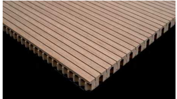
Typ SL 3/8-16 Sichtseite B=3mm Achsabstand 16mm Rückseite 8mm T-Lochung Typ SL 3/12-16 Sichtseite B=3mm Achsabstand 16mm Rückseite 12mm T-Lochung
