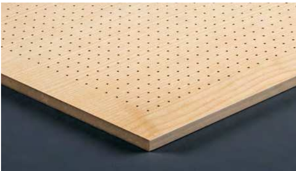
Typ L 1,2/3-8, D=1,2mm, Achsabstand 8mm Rückseite T-Lochung D=3mm
