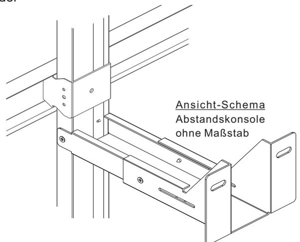
Um eine kraftschlüssige Verbindung zwischen Wand und Unterkonstruktion herzustellen, dürfen nur zugelassene Verbindungsmittel verwendet werden. Die Hinweise der Hersteller, der Befestigungsmaterialien, wie Dübel-/Schrauben und die Montagehinweise der jeweils zum Einsatz kommenden Wandsysteme sind zu berücksichtigen. Die Befestiger werden durch die Abstandskonsolen wie im Detail dargestellt, ersetzt und mit der Unterkonstruktion verbunden.
