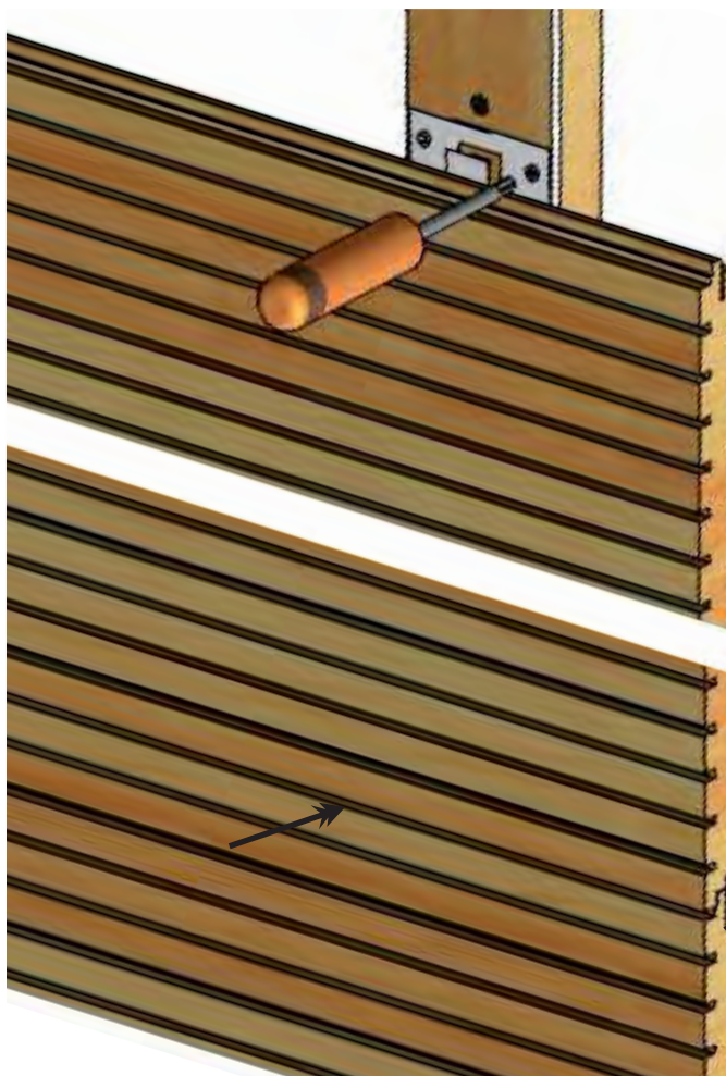
Bild 1: Befestigung mit Spezial-Druckluftnagler 6 Schraubkralle
