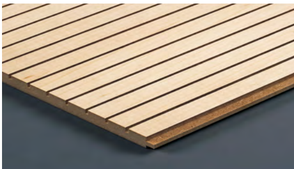
Typ S 2-16 Sichtseite B=2mm Achsabstand 16mm Typ ST 2-16 Sichtseite B=2mm Achsabstand 16mm Rückseite teilweise 8mm zusätzlich ausgefräst
