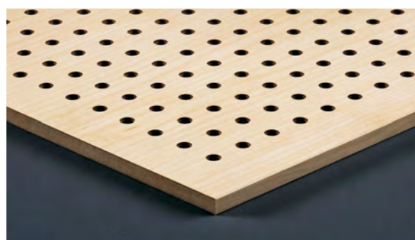
BER Holz F C-MF Akustikplatte Typ L 6-16, D=6mm Achsabstand 16mm Sichtseite Furnier Eiche, Birke, Ahorn, Lärche
