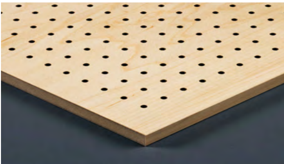
Typ L 4/12-16 Sichtseite D=4mm Achsabstand 16mm Rückseite T-Lochung D=12mm
