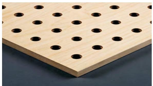
Typ L 12-32 Sichtseite D=12mm Achsabstand 32mm
