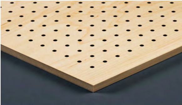
Typ L 4-16 Sichtseite D=4mm Achsabstand 16mm
