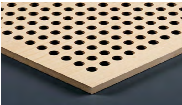
Typ L 10-16, D=10mm, Achsabstand 16mm
