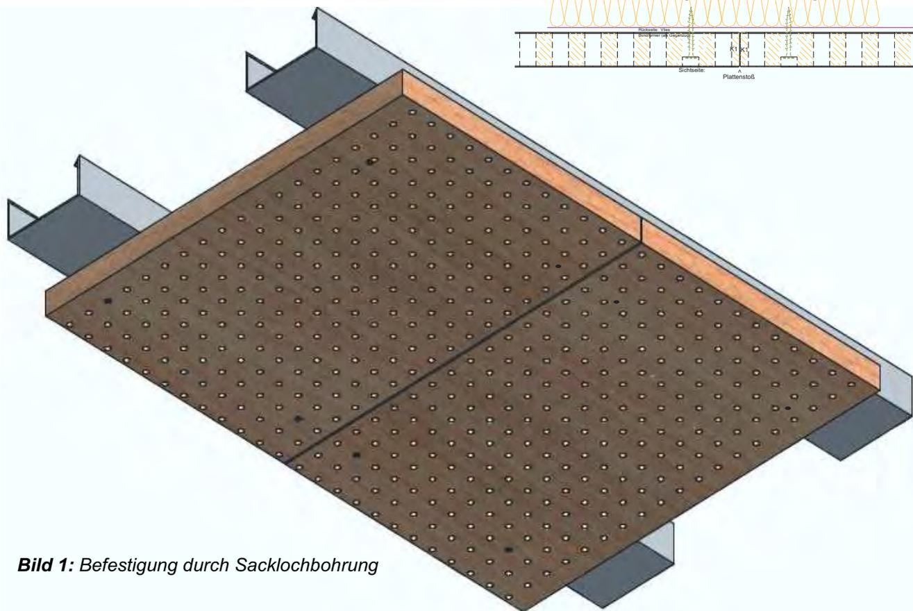
**Bild 1:** Befestigung durch Sacklochbohrung
