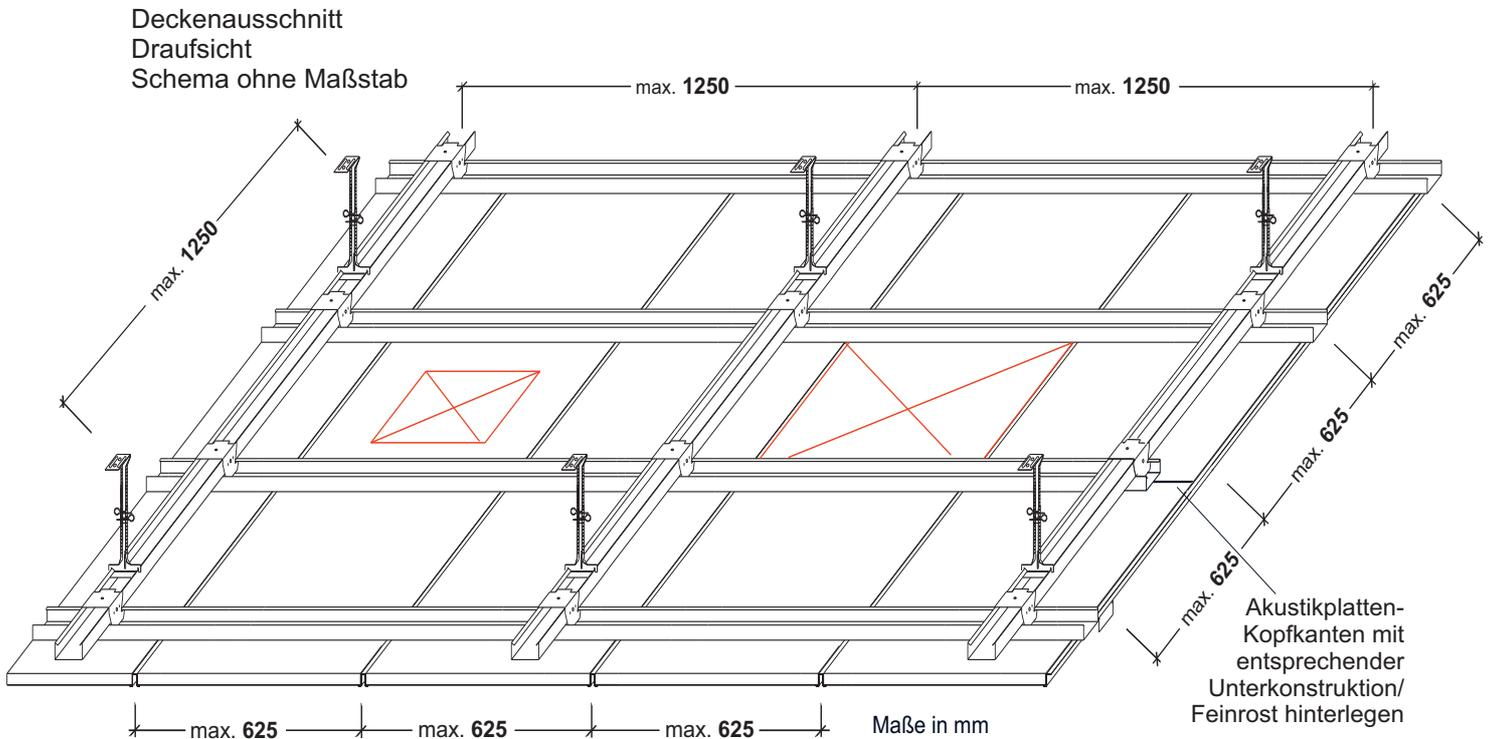
An dem äußeren Rahmen eines Aluminium-Profil mit dem die werkseitig vorgefertigte Revisionsklappe eingefasst ist, wird sie dem System entsprechend rückseitig durch Verschraubung mit entsprechender Anzahl Schrauben, 5 x 20 mit der ballwurfsicherer Akustikplatte verbunden.
