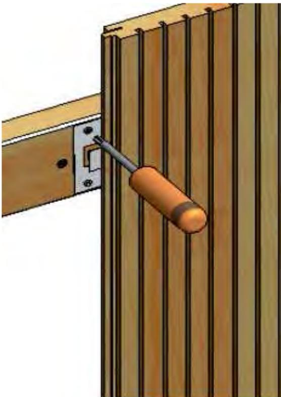
**Bild 1:** Nut- / Kammverbindung
