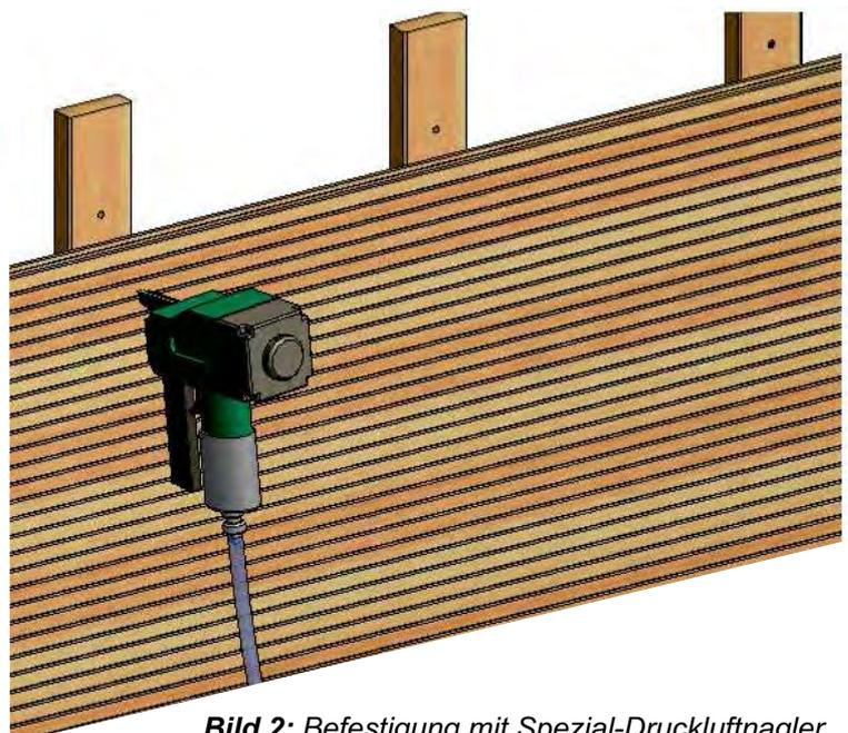
**Bild 2:** Befestigung mit Spezial-Druckluftnagler
