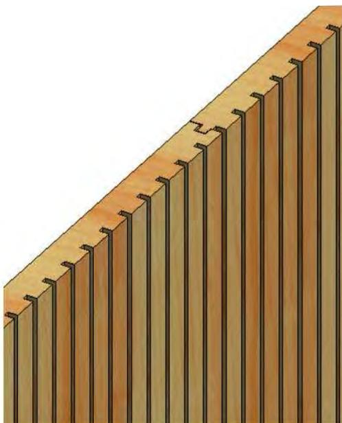
**Bild 1:** Nut- / Kammverbindung
