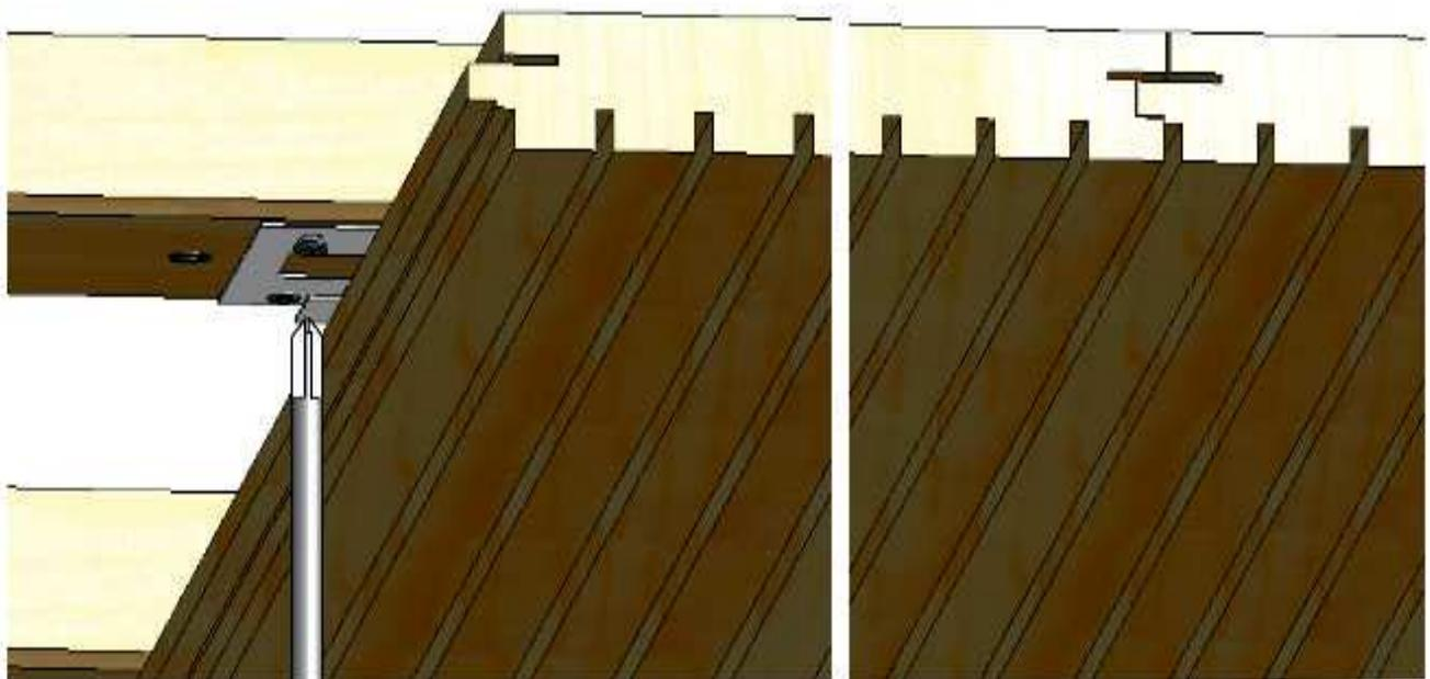
**Bild 2:** Befestigung mit Schraubkralle
