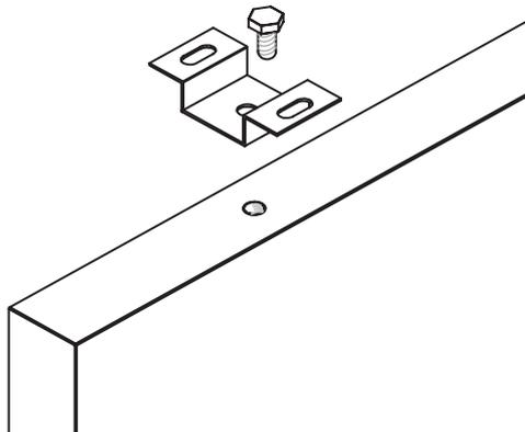
Um eine kraftschlüssige Verbindung zwischen Rohdecke und Abhängesystem herzustellen, dürfen nur zugelassene Verbindungsmittel verwendet werden. Die Hinweise der Hersteller der Befestigungsmaterialien, wie z.B. Dübel/Schrauben sind zu berücksichtigen!
