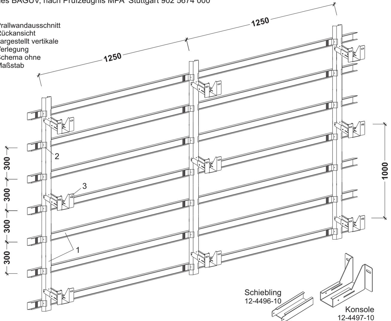
BER-Akustikplatten die Kopfkanten müssen mit entsprechender Unterkonstruktion/Feinrost hinterlegt werden
