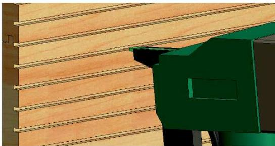
**Bild 1:** Nut- / Kammverbindung
