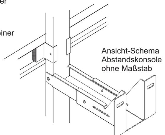
Um eine kraftschlüssige Verbindung zwischen Wand und Unterkonstruktion herzustellen, dürfen nur zugelassene Verbindungsmittel verwendet werden. Die Hinweise der Hersteller, der Befestigungsmaterialien, wie Dübel-/Schrauben und die Montagehinweise der jeweils zum Einsatz kommenden Prallwandsysteme sind zu berücksichtigen. Die Befestiger werden durch die Abstandskonsolen wie im Detail dargestellt, ersetzt und mit der Unterkonstruktion verbunden.
