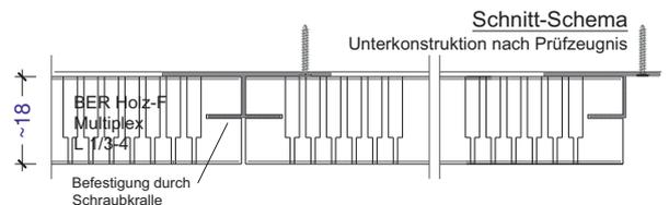
BER Holz-F Akustikplatte, Typ L 1/3-4, kleinere Perforierung mit gleichen oder größeren Lochabständen sind zulässig. Gewicht für diesen Typ nach Anfrage.
