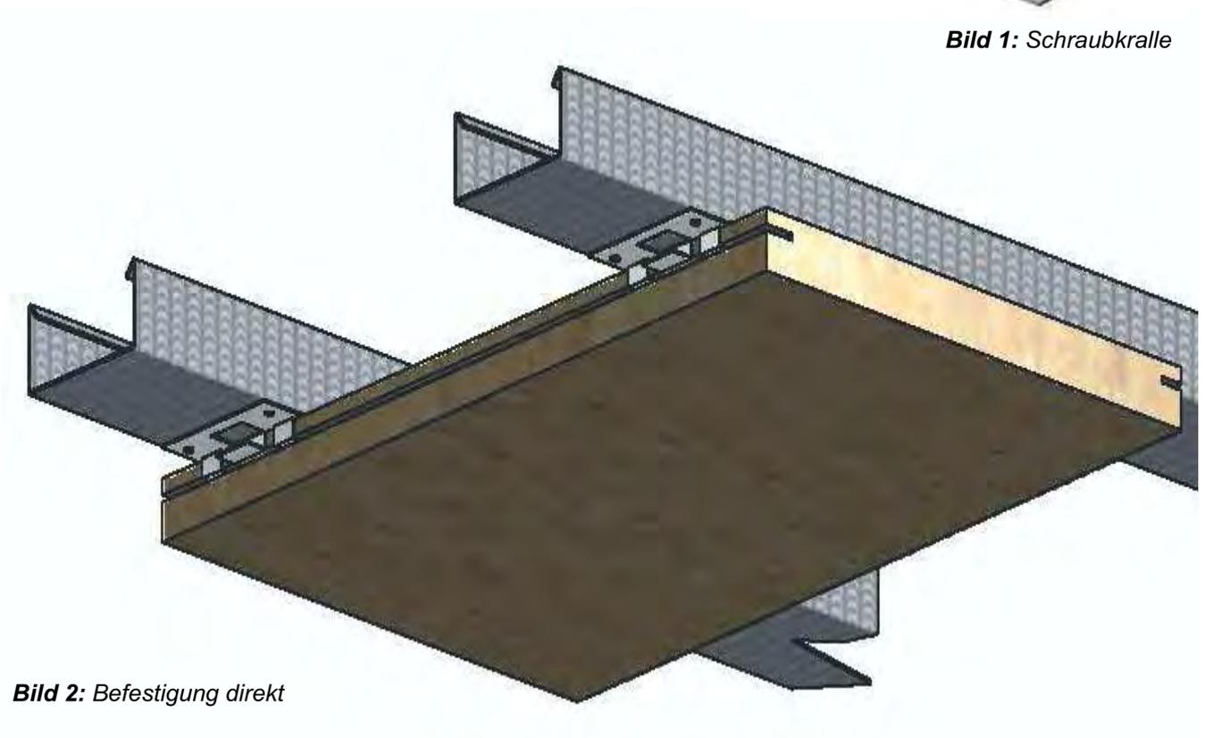
**Bild 2:** Befestigung direkt
