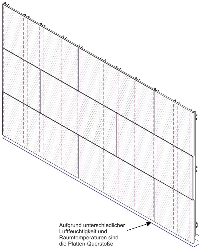
Aufgrund unterschiedlicher Luftfeuchtigkeit und Raumtemperaturen sind die Platten-Querstöße mit einer Fuge von 1-1,5mm je Lfdm. auszubilden, damit bei schwankender Raumfeuchte Veränderungen in der Länge aufgenommen werden können.
