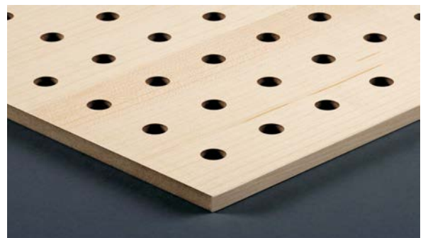
Typ L 10-32, D=10mm, Achsabstand 32mm
