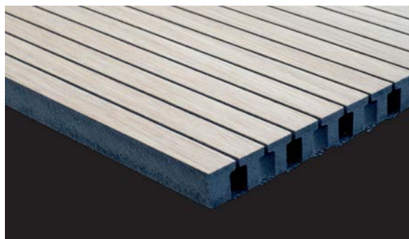
BER Holz F C-DF Akustikplatten Typ SL 3/8-16, B=3mm im Abstand 16mm Rückseite T-Lochung D=8mm Sichtseite Furnier Eiche oder Buche
