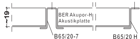
Schnitt-Schema Unterkonstruktion nach Prüfzeugnis
