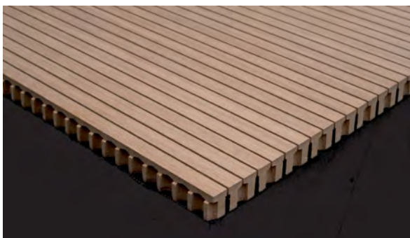
BER Holz F C-MF Akustikplatten Typ SL 2/8-16, B=2mm im Abstand 16mm Rückseite T-Lochung D=8mm Sichtseite Furnier Birke und Eiche
