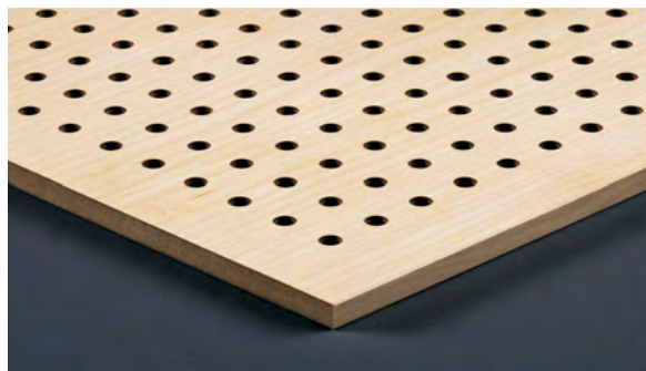
BER Holz F C-MF Akustikplatte Typ L 6-16, D=6mm Achsabstand 16mm Sichtseite Echtholz furnier Birke
