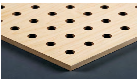
Typ L 12-32 Sichtseite D=12mm Achsabstand 32mm
