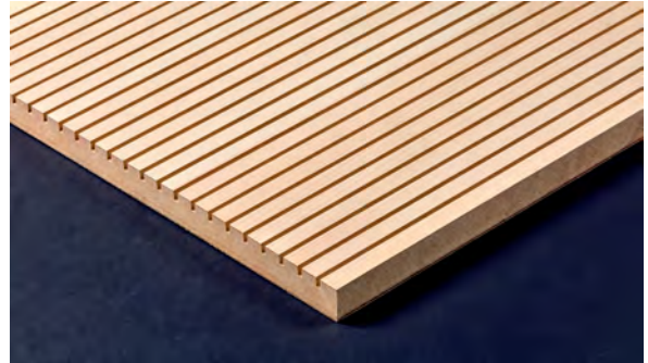
Typ SL 3/8-16 Sichtseite B=3mm Achsabstand 16mm Rückseite T-Lochung D=8mm Typ SL 3/12-16 Sichtseite B=3mm Achsabstand 16mm Rückseite T-Lochung D=12mm
