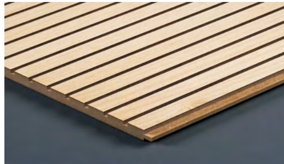
Typ S 3-16 Sichtseite B=3mm Achsabstand 16mm Typ ST 3-16 Sichtseite B=3mm Achsabstand 16mm Rückseite teilweise 8mm zusätzlich ausgefräst
