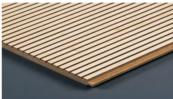
Typ S 2-8 Sichtseite B=2mm Achsabstand 8mm Typ S 2/3-8 Sichtseite 2mm Achsabstand 8mm Rückseite teilweise 3mm zusätzlich hinterfräst
