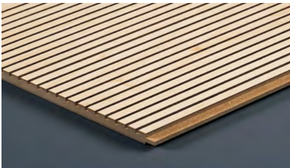
Typ S 2-8, B=2mm, Achsabstand 8mm Typ S 2/3-8, B=2mm, Achsabstand 8mm Rückseite B=3mm
