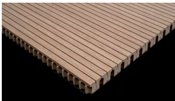
Typ SL 3/8-16 Sichtseite B=3mm Achsabstand 16mm Rückseite 8mm T-Lochung Typ SL 3/12-16 Sichtseite B=3mm Achsabstand 16mm Rückseite 12mm T-Lochung
