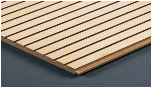
Typ ST 4-16 Sichtseite B=4mm Achsabstand 16mm Rückseite teilweise 8mm zusätzlich ausgefräst
