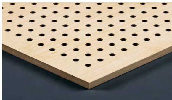
Typ L 5/12-16 Sichtseite D=5mm Achsabstand 16mm Rückseite T-Lochung D=12mm
