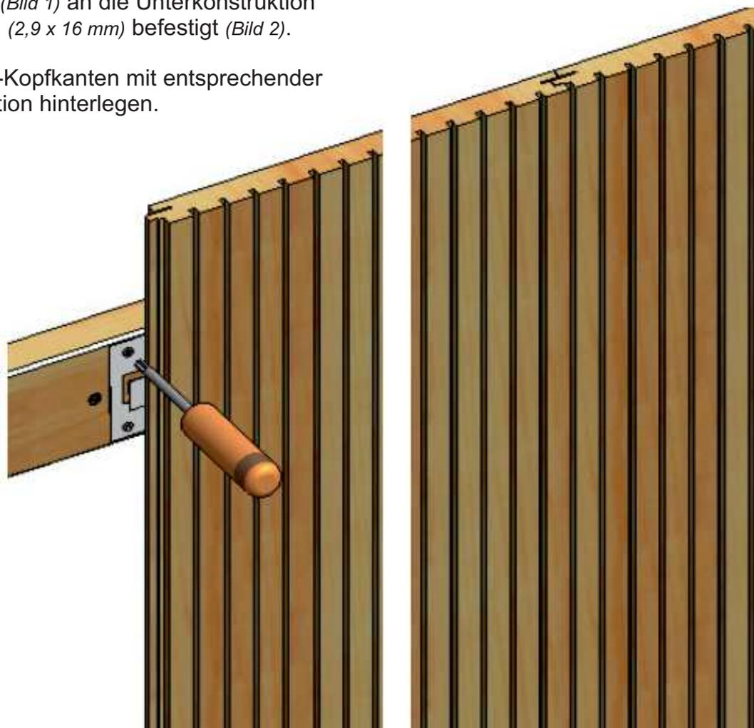
*Bild 2: Befestigung Ansicht-Schema*
