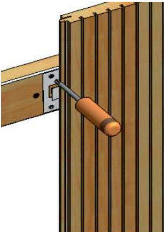
*Bild 1:* Nut- / Kammverbindung
