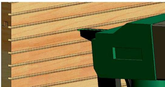
*Bild 1: Nut- / Kammverbindung*
