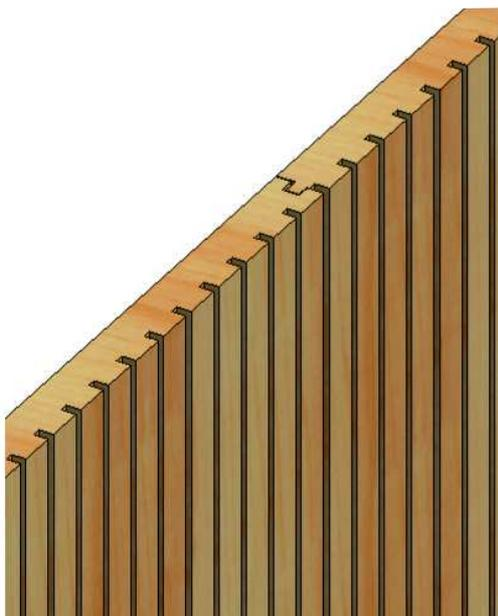
*Bild 1:* Nut- / Kammverbindung
