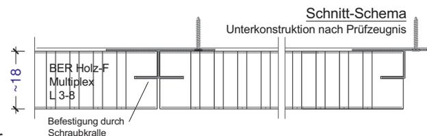
BER Holz-F Akustikplatte, Typ L 3-8, kleinere Perforierung mit gleichen oder größeren Lochabständen sind zulässig. Gewicht für diesen Typ nach Anfrage.
