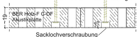
BER Holz-F C-DF Akustikplatte, max. Lochung 8-16, kleinere Lochung mit gleichen oder größeren Lochabständen sind zulässig, für diese Lochbilder das Gewicht bitte anfragen
