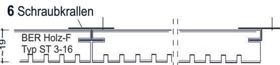
BER Holz-F Akustikplatte, Typ ST 3-16, kleinere Schlitzungen mit gleichen oder größeren Schlitzabständen sind zulässig für diese Schlitzbilder bitte das Gewicht anfragen.
