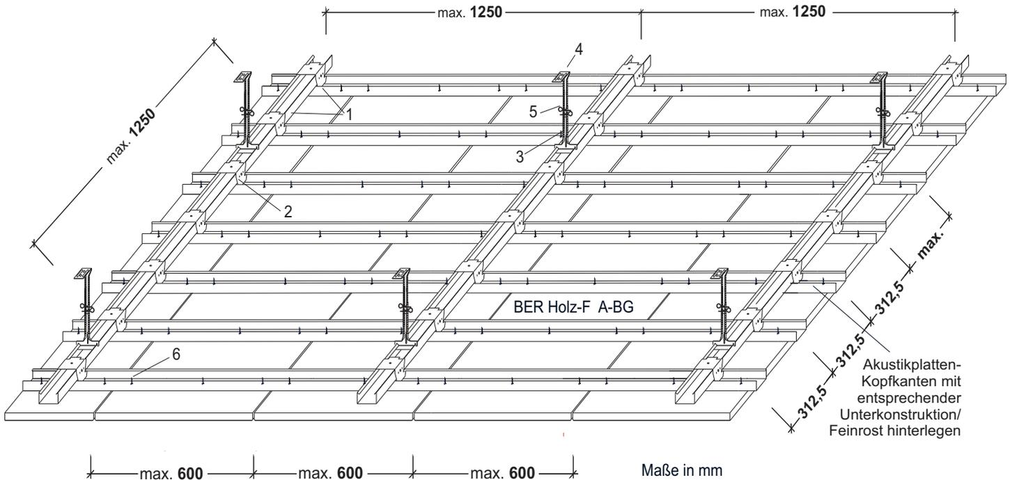
BER Holz-F A-BG Akustikplatte, max. Lochung 8-16, kleinere Lochung mit gleichen oder größeren Lochabständen sind zulässig, für diese Lochbilder das Gewicht bitte anfragen
