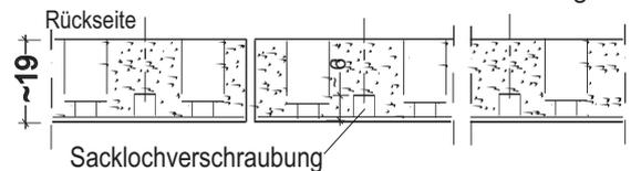
BER 3-Schicht Akustikplatte, Typ L 6/12-16, kleinere Perforierung mit gleichen oder größeren Lochabständen sind zulässig. Gewicht für diesen Typ nach Anfrage.
