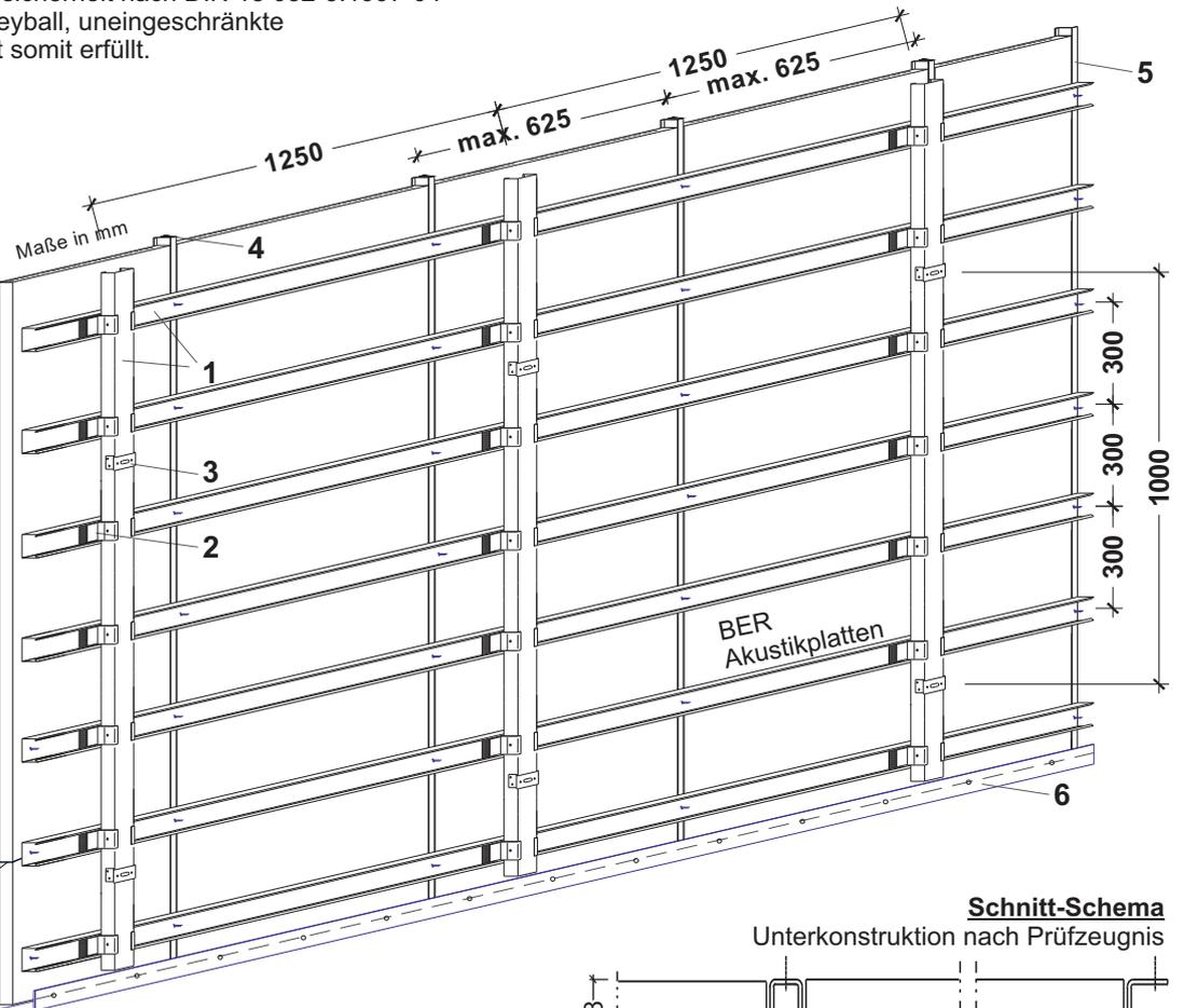
Akustikplatten-Kopfanten mit entsprechender Unterkonstruktion/ Feinrost hinterlegen
