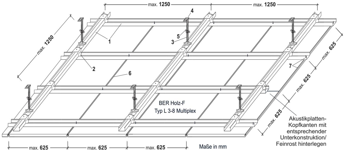
BER Holz-F Akustikplatte, max. Lochung 3-8, kleinere Lochung mit gleichen oder größeren Lochabständen sind zulässig, für diese Lochbilder das Gewicht bitte anfragen.
