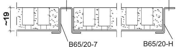
BER Holz-F A-BG Akustikplatte, max. Lochung 6/12-16, kleinere Lochung mit gleichen oder größeren Lochabständen sind zulässig für diese Lochbilder bitte das Gewicht anfragen.
