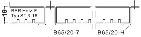
BER Holz-F Akustikplatte, Typ ST 3-16, kleinere Schlitzungen mit gleichen oder größeren Schlitzabständen sind zulässig für diese Schlitzbilder bitte das Gewicht anfragen.
