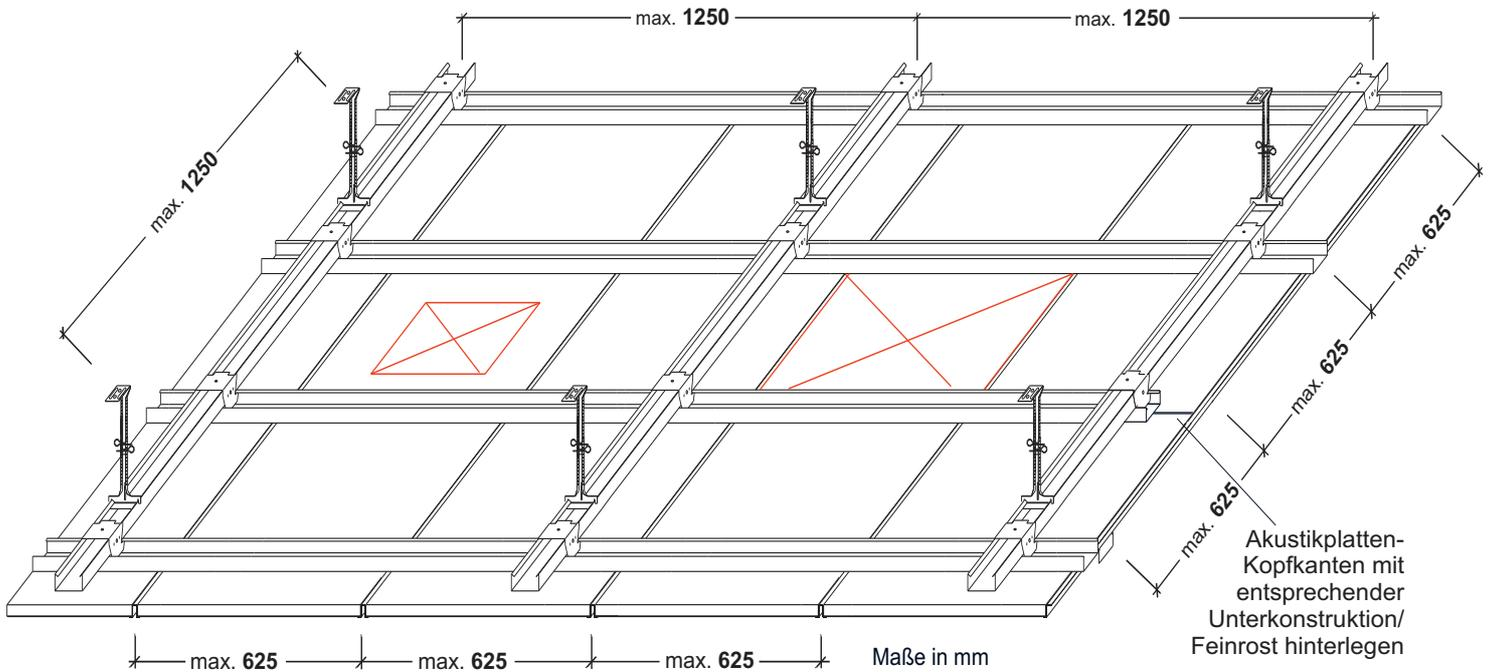
An dem äußeren Rahmen eines Aluminium-Profil mit dem die werkseitig vorgefertigte Revisionsklappe eingefasst ist, wird sie dem System entsprechend rückseitig durch Verschraubung mit entsprechender Anzahl Schrauben, 5 x 20 mit der ballwurfsicherer Akustikplatte verbunden.
