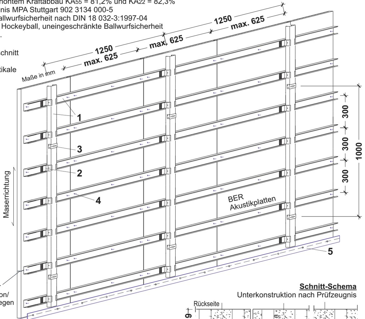
Akustikplatten-Kopfanten mit entsprechender Unterkonstruktion/Feinrost hinterlegen
