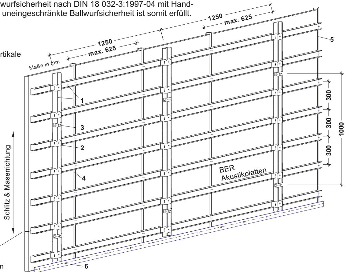
BER Holz-F Akustikplatte, Typ ST 3-16, kleinere Schlitzungen mit gleichen oder größeren Schlitzabständen sind zulässig für diese Schlitzbilder bitte das Gewicht anfragen.
