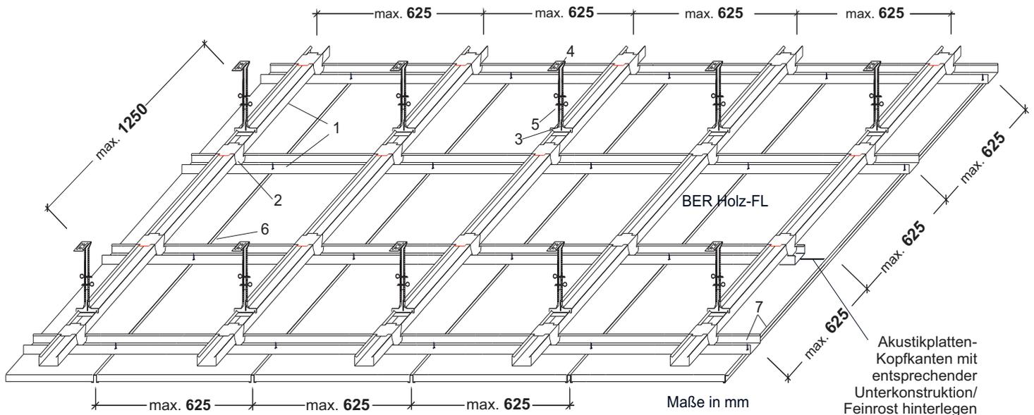
BER Holz-F Akustikplatte, max. Lochung 1/3-4, kleinere Lochung mit gleichen oder größeren Lochabständen sind zulässig, für diese Lochbilder das Gewicht bitte anfragen
