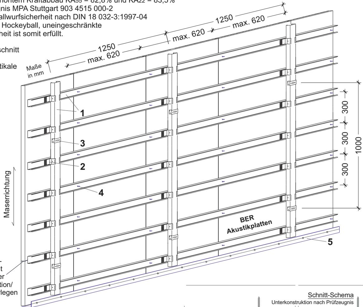
Akustikplatten-Kopfkanten mit entsprechender Unterkonstruktion/Feinrost hinterlegen
