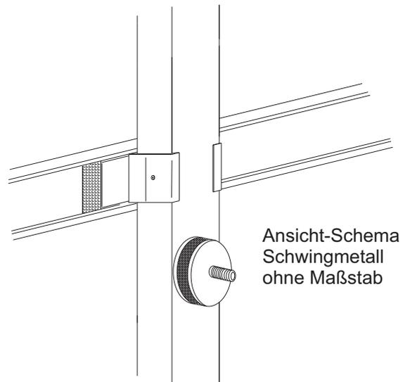
Gewicht der Unterkonstruktion ca. 3,20 Kg/m<sup>2</sup>
