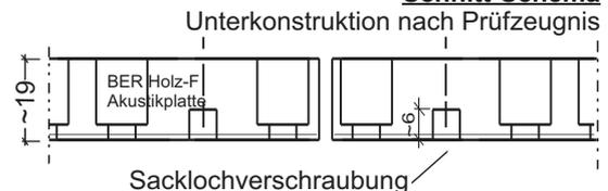
BER Holz-F Akustikplatte, max. Lochung 8/12-16, kleinere Lochung mit gleichen oder größeren Lochabständen sind zulässig, für diese Lochbilder das Gewicht bitte anfragen
