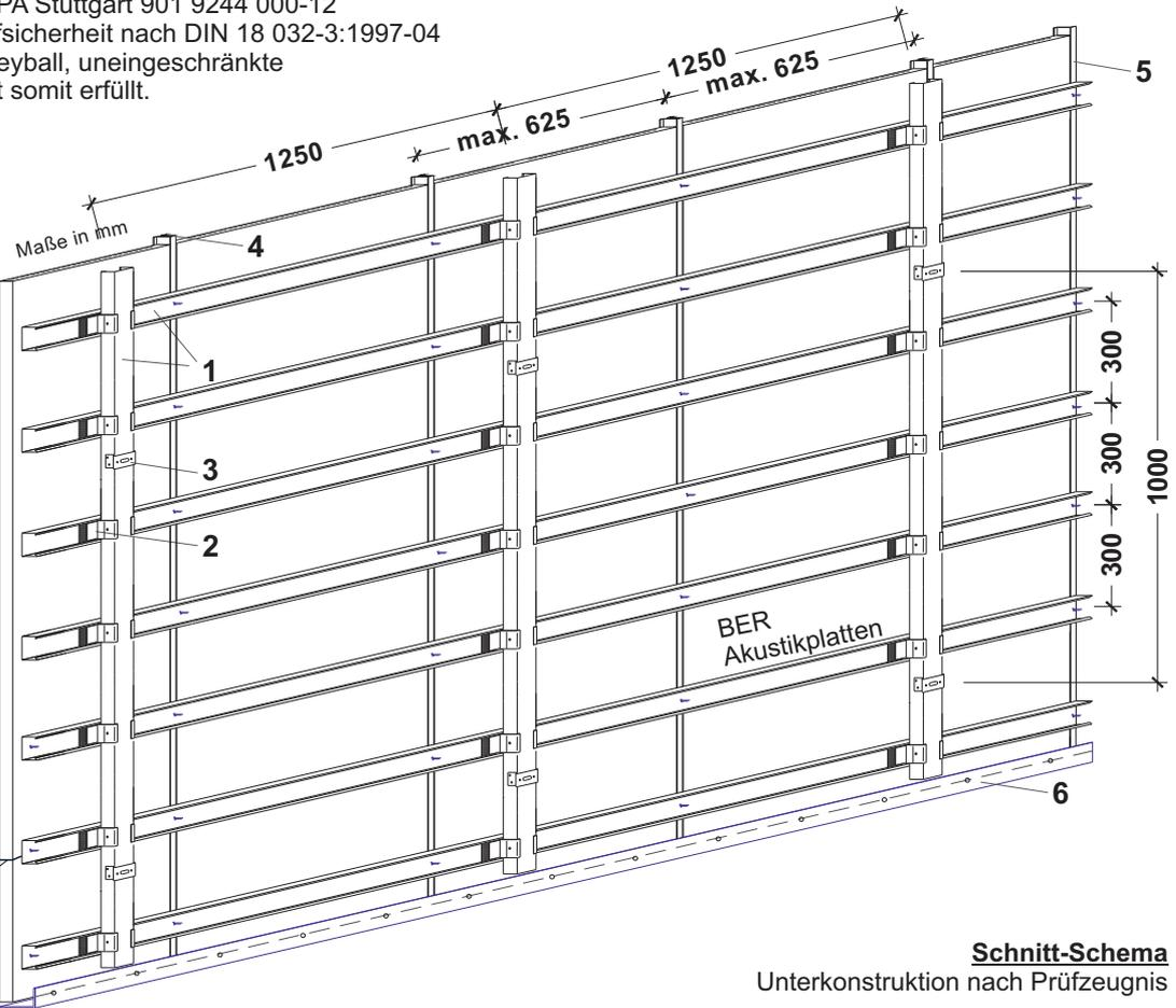
Akustikplatten-Kopfanten mit entsprechender Unterkonstruktion/ Feinrost hinterlegen
