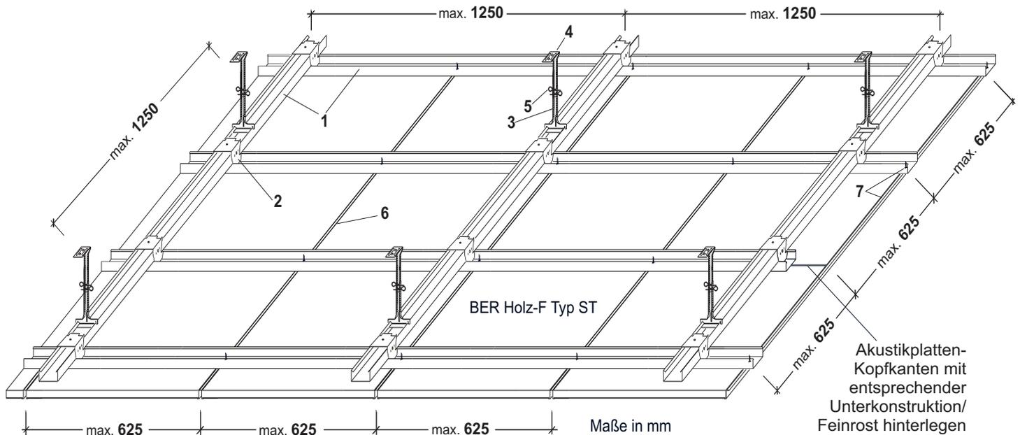
BER Holz-F Akustikplatte, max. Schlitzung ST 3-16, kleinere Schlitzung mit gleichen oder größeren Schlitzabständen sind zulässig, für diese Schlitzbilder bitte das Gewicht anfragen.
