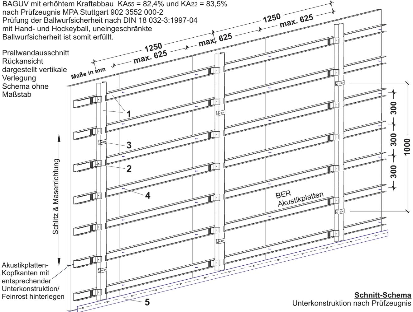
BER Holz-F C-DF Akustikplatte, Typ SL 3/8-16, kleinere Schlitzungen mit gleichen oder größeren Schlitzabständen sind zulässig für diese Schlitzbilder bitte das Gewicht anfragen.
