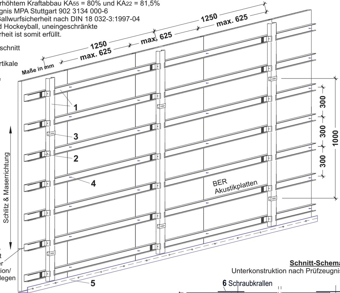
BER Holz-F Akustikplatte, Typ ST 3-16, kleinere Schlitzungen mit gleichen oder größeren Schlitzabständen sind zulässig für diese Schlitzbilder bitte das Gewicht anfragen.
