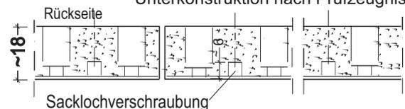
BER Holz-F Multiplex Akustikplatten, max. Lochung 6/12-16, kleinere Lochungen mit gleichen oder größeren Lochabständen sind zulässig, für diese Lochbilder bitte das Gewicht anfragen
