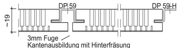
BER Holz-F Akustikplatte, max. Lochung 1/3-4, kleinere Lochung mit gleichen oder größeren Lochabständen sind zulässig, für diese Lochbilder das Gewicht bitte anfragen
