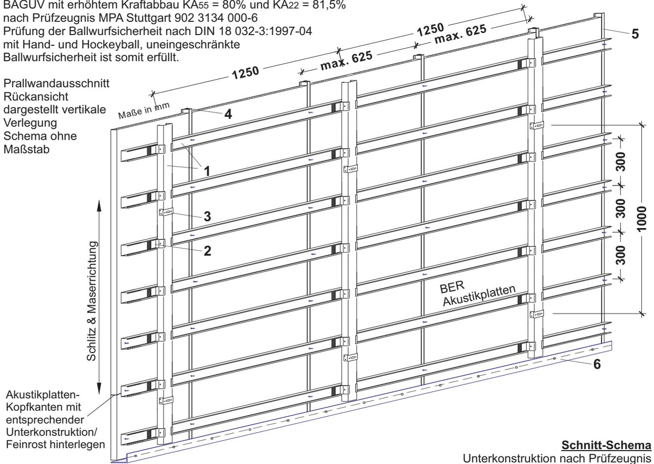
Akustikplatten-Kopfanten mit entsprechender Unterkonstruktion/Feinrost hinterlegen
