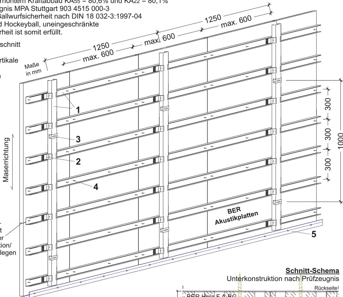
Akustikplatten-Kopfanten mit entsprechender Unterkonstruktion/Feinrost hinterlegen
