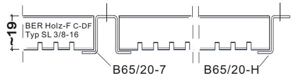
BER Holz-F C-DF Akustikplatte, Typ SL 3/8-16, kleinere Schlitzungen mit gleichen oder größeren Schlitzabständen sind zulässig für diese Schlitzbilder bitte das Gewicht anfragen.
