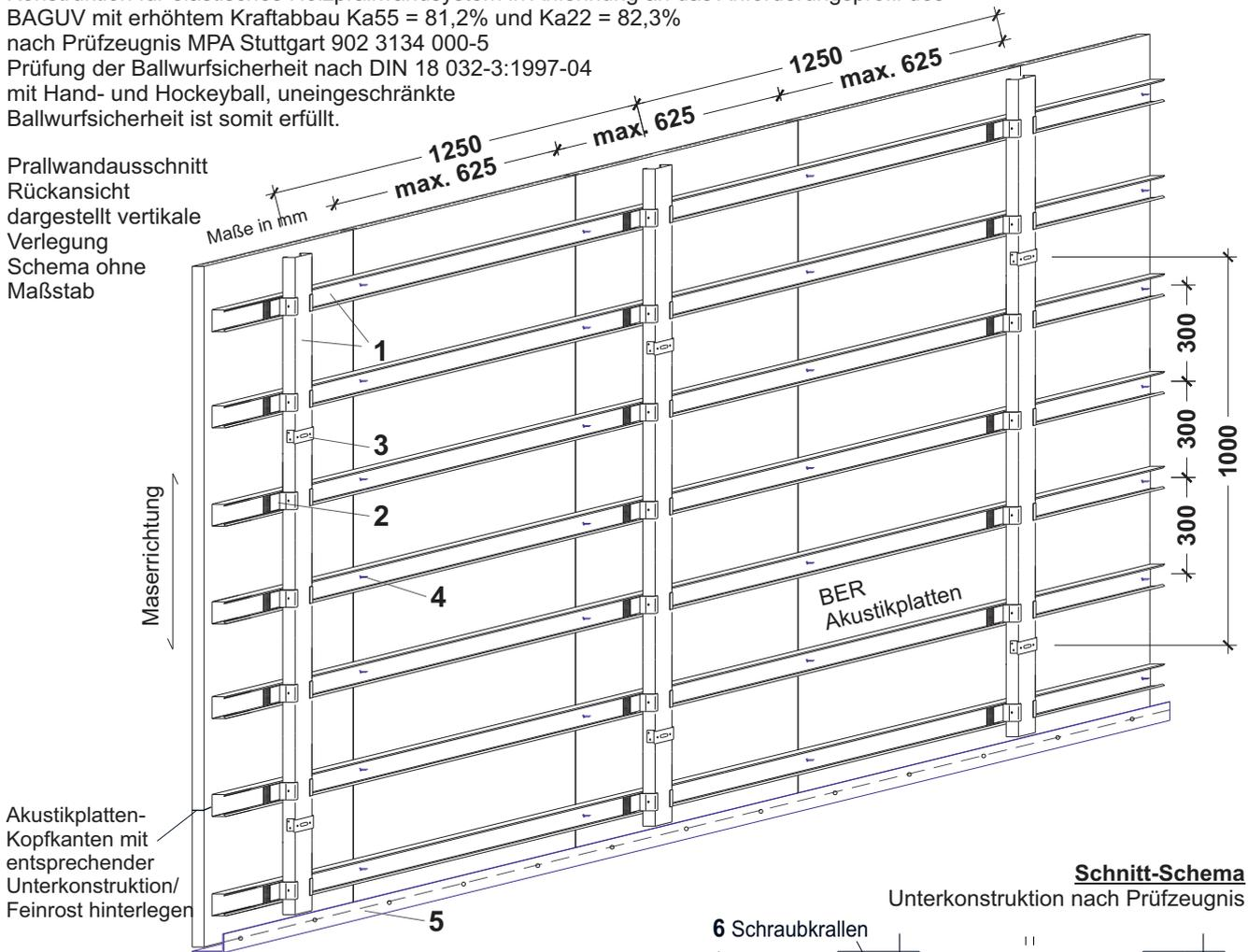
BER 3-Schicht Akustikplatte, Typ L 6/12-16, kleinere Perforierung mit gleichen oder größeren Lochabständen sind zulässig. Gewicht für diesen Typ nach Anfrage.
