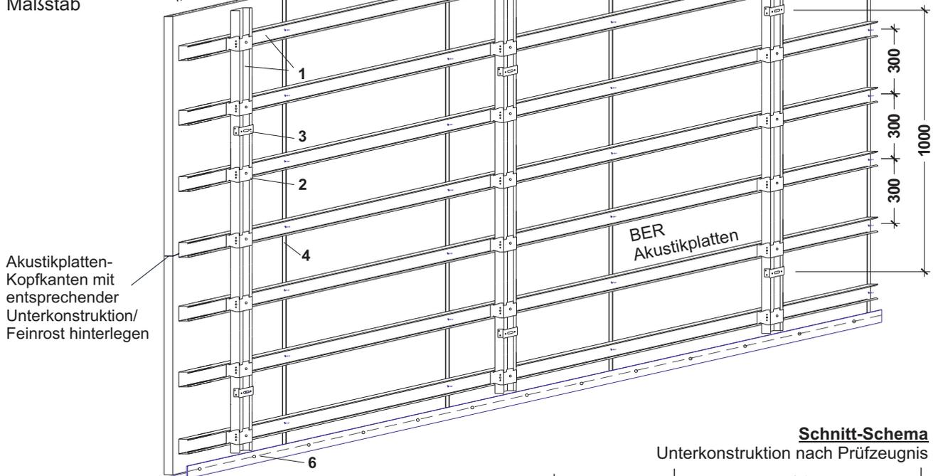
BER Holz-F A-BG Akustikplatte, max. Lochung 6/12-16, kleinere Lochung mit gleichen oder größeren Lochabständen sind zulässig für diese Lochbilder bitte das Gewicht anfragen.
