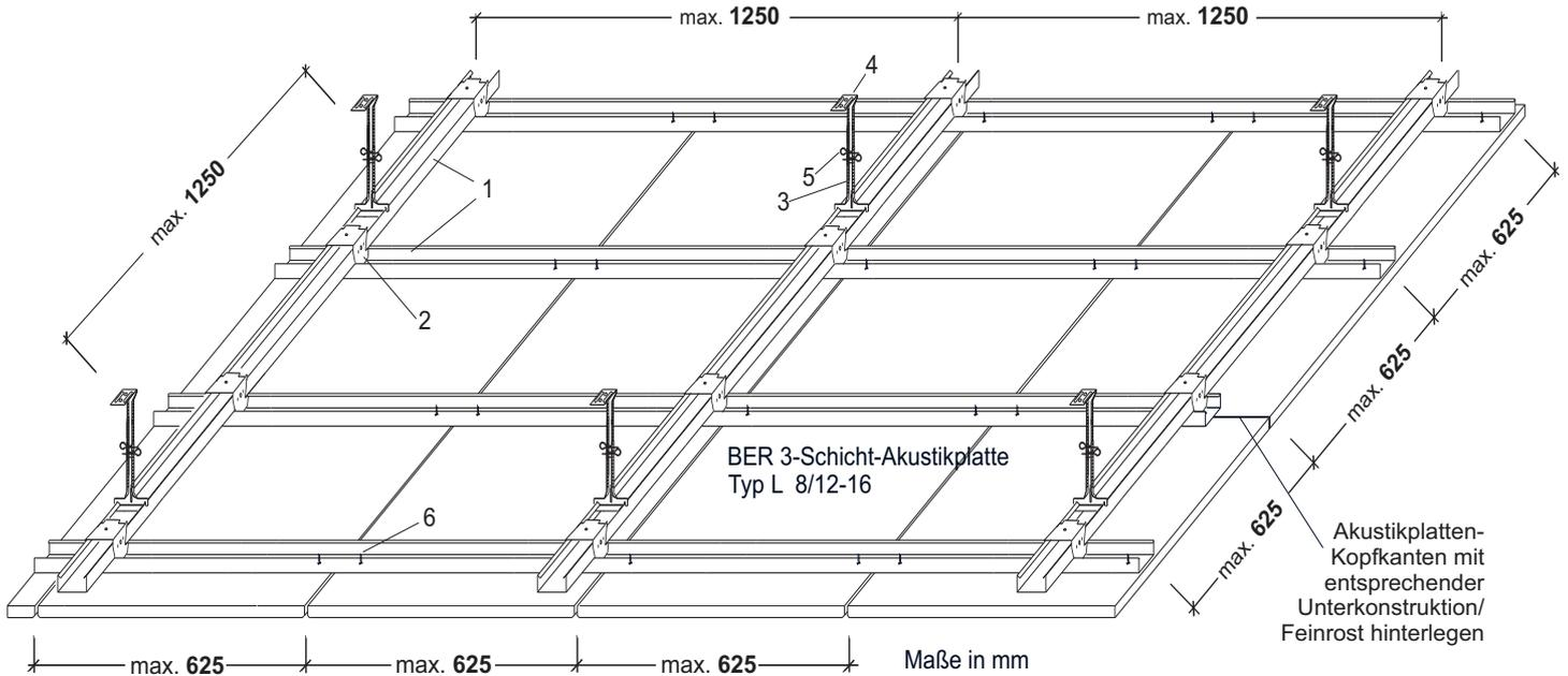
BER 3-Schicht Akustikplatte, max. Lochung 8/12-16, kleinere Lochung mit gleichen oder größeren Lochabständen sind zulässig, für diese Lochbilder das Gewicht bitte anfragen
