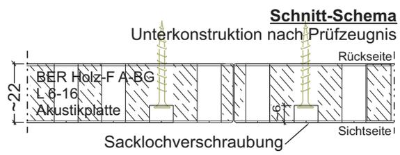
BER Holz-F A-BG Akustikplatten, max. Lochung 6-16, kleinere Lochungen mit gleichen oder größeren Lochabständen sind zulässig, für diese Lochbilder bitte das Gewicht anfragen
