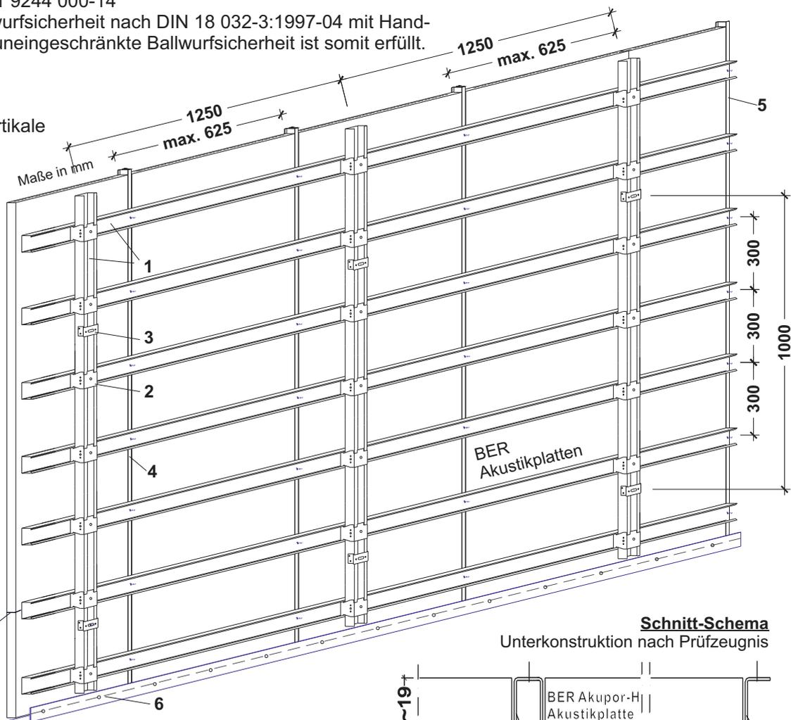
Akustikplatten-Kopfanten mit entsprechender Unterkonstruktion/Feinrost hinterlegen
