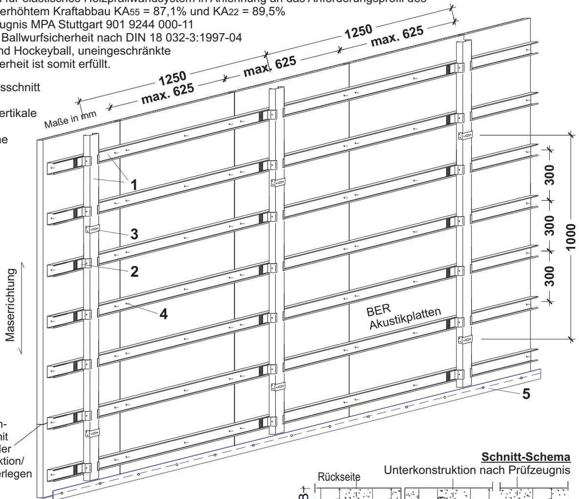
BER Holz-F Multiplex Akustikplatten, max. Lochung 6/12-16, kleinere Lochungen mit gleichen oder größeren Lochabständen sind zulässig, für diese Lochbilder bitte das Gewicht anfragen
