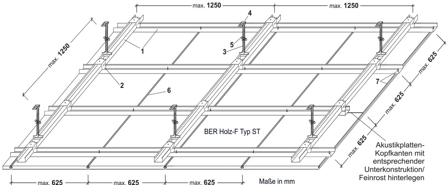
BER Holz-F Akustikplatte, max. Schlitzung ST 3-16, kleinere Schlitzung mit gleichen oder größeren Schlitzabständen sind zulässig, für diese Schlitzbilder bitte das Gewicht anfragen.
