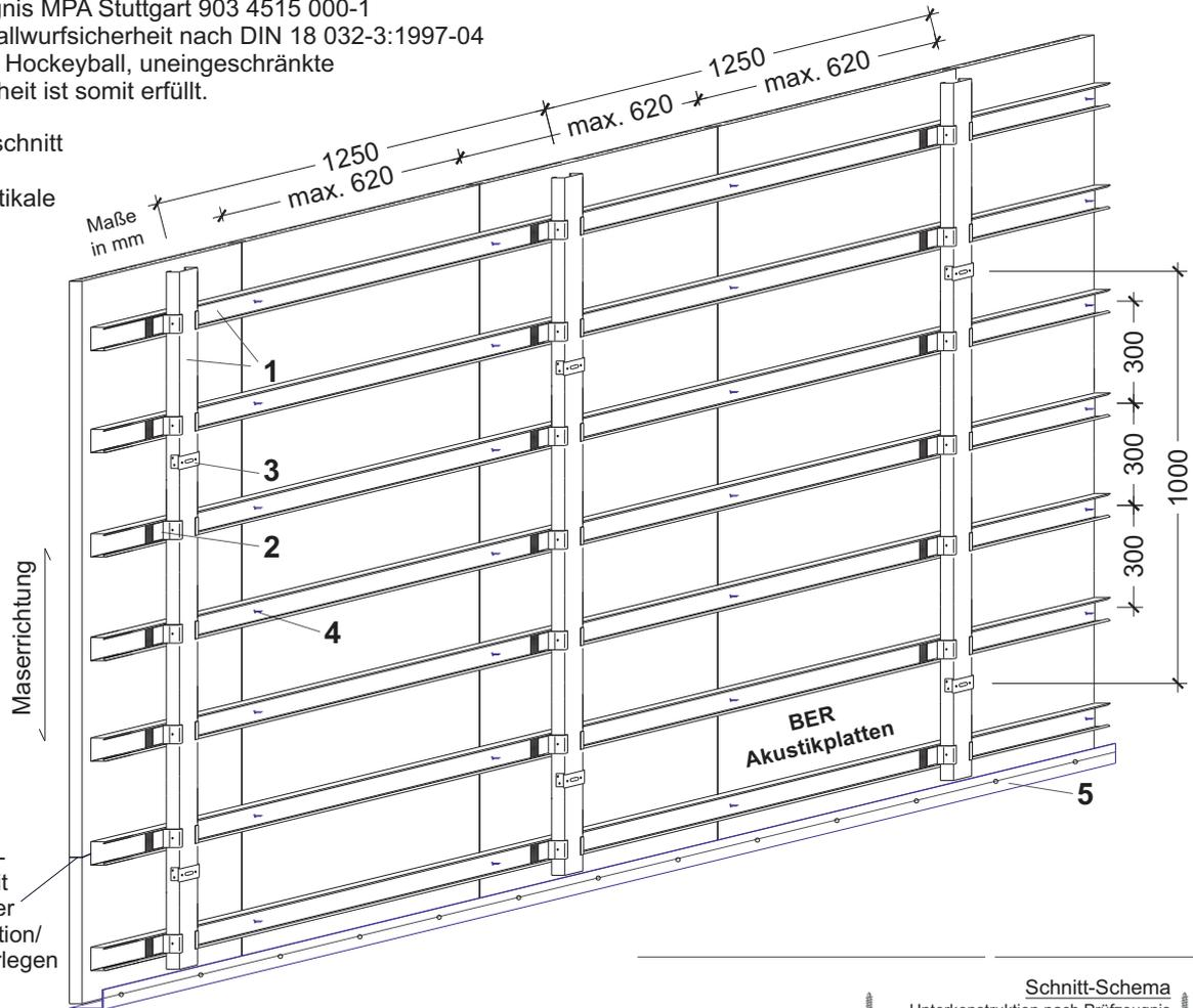
BER Holz-F Akustikplatte, Typ L 1/3-4, kleinere Perforierung mit gleichen oder größeren Lochabständen sind zulässig.
