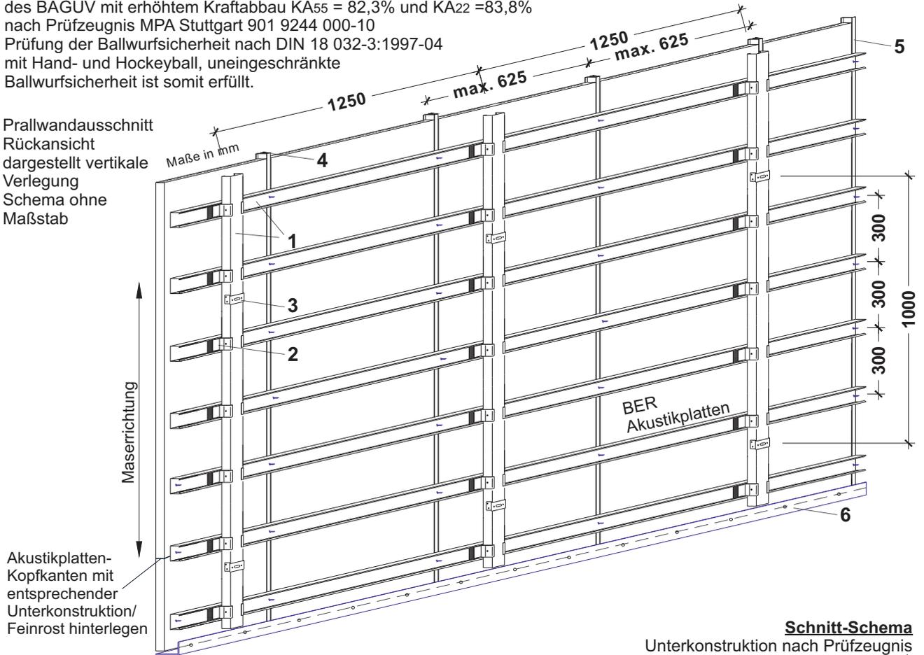
Akustikplatten-Kopfkanten mit entsprechender Unterkonstruktion/Feinrost hinterlegen
