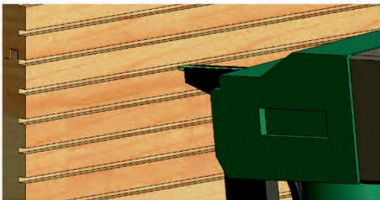
*Bild 1: Nut- / Kammverbindung*
