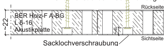
Schnitt-Schema Unterkonstruktion nach Prüfzeugnis
