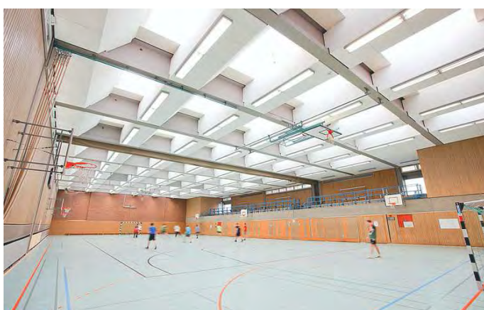
Sporthalle Europa-Gymnasium Wörth BER Sonoplus Akustikplatte als ballwurfsichere Deckenverkleidung Sonderkonstruktion
