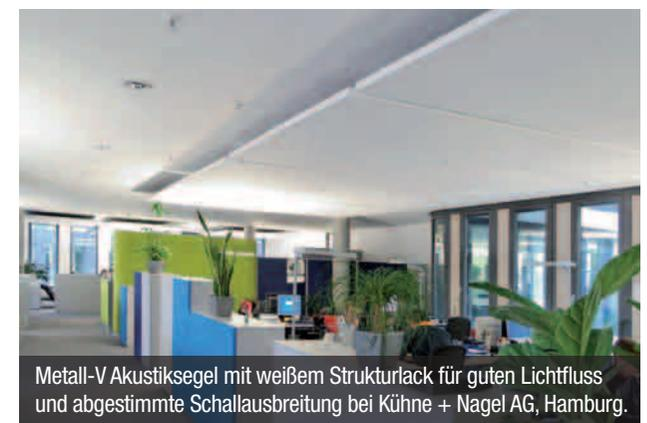
In architektonisch komplexen Situationen sorgt die Kombination von Akustikplatten mit akustischen Teilflächen für eine besonders ausgewogene Raumakustik. Die Elemente wirken punktuell schallabsorbierend und ermöglichen die richtige Mischung von Nachhallzeitregulierung und optimaler Sprachverständlichkeit. Gerade in anspruchsvollen Räumen lassen sich so Parameter wie Klarheitsmaß, Deutlichkeitsgrad, Bassverhältnis und Hallmaß gut steuern.
